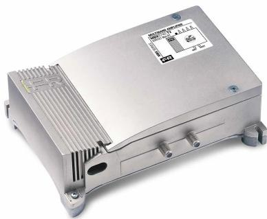
Station pour intérieur auto-alimentée à 4 entrées (FM, III+DAB, UHF) avec un gain de 31dB et un niveau de sortie jusqu'à 125dB $\mu$ V dans la bande UHF, amplification séparée des bandes, réglage du gain indépendant (0-20dB) pour chaque entrée et faible facteur de bruit. **Technologie T2** avec filtre intégré pour éliminer les interférences 5G à 694MHz.
